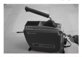
1) Пропустите гибкий вал через машину. Никогда не соединяйте более одного гибкого вала одновременно.
