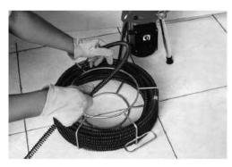
8) Как только засор устранен, поверните переключатель в положение ОFF. Вытяните гибкий вал из трубы. После использования тщательно промойте и слейте воду из гибкого вала, муфты и насадки, чтобы избежать повреждающего действия некоторых составов для очистки сливов. Вытрите их насухо. Сохраните для дальнейшего использования.
