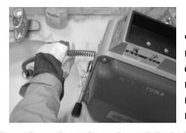
7) Пропустите достаточно длины гибкого вала через машину, чтобы образовалась почти полуокружность между машиной и отверстием слива. С зажатой рукой в перчатке на гибком шланге надавите на рукоятку другой рукой, чтобы начать вращение гибкого вала. Надавите на верхнюю часть петли гибкого вала для
