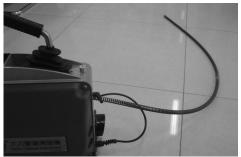
4) Выпустите гибкий вал на 2~4 м из задней части машины. Уберите остальную часть вала для дальнейшего использования.
