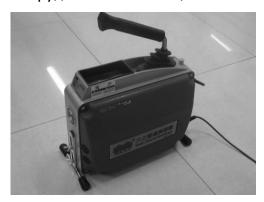
9) После использования позвольте мотору свободно работать 2-3 минуты. Впрысните смазочное масло в масляные отверстия. Можно использовать машинное масло. Уберите машину в сухое место для использования в будущем.
